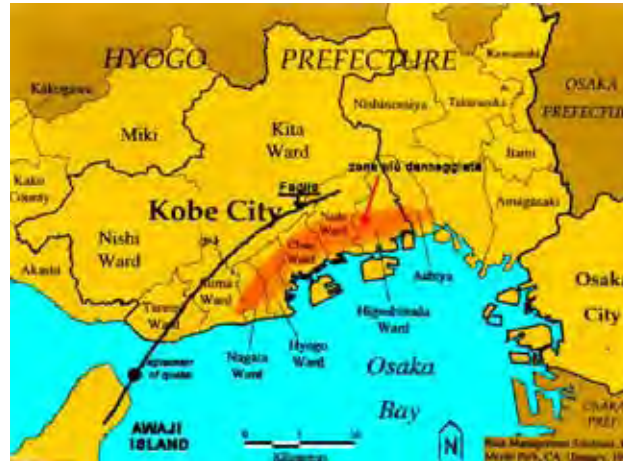
Figura 5.4. Città di Kobe con indicazione della faglia e della zona più danneggiata. ( Kobe City map with fault and most damaged area ).
